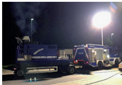
GKW II und das 100kVA Aggregat im Einsatz
